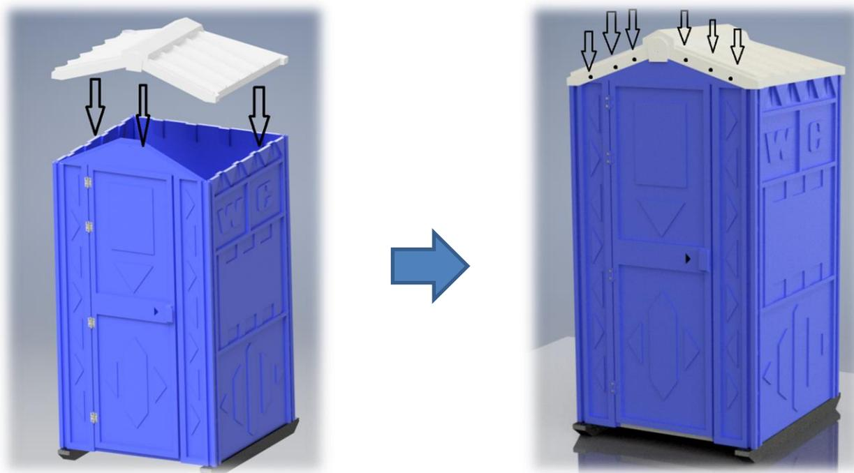
3.1.6. Просверлить 15 отверстий в крыше и трех боковых панелях (по 5 отверстий на каждую сторону), ориентируясь на специальные ребра жесткости, и закрепить вытяжными заклепками (4,8x16 мм) с шайбой
