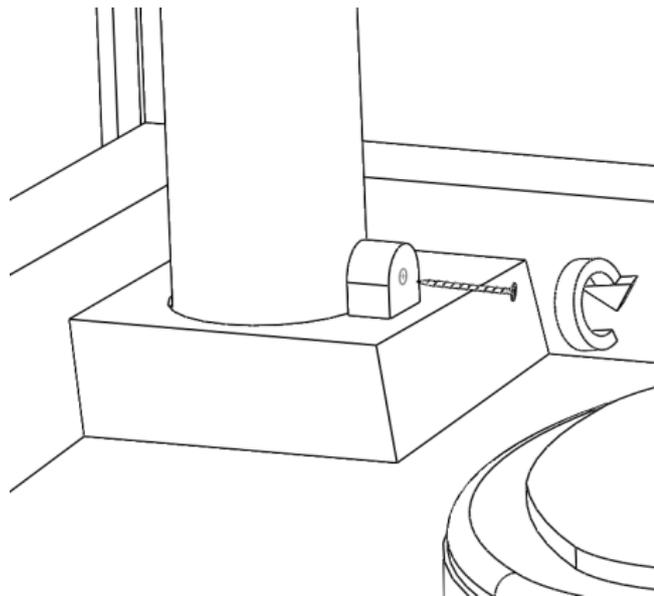
3.1.9.Просверлить отверстия в двери и закрепить вытяжной заклепкой (4,8x18 мм) проушину для замка. Вторую проушину закрепить таким же образом на арке:
