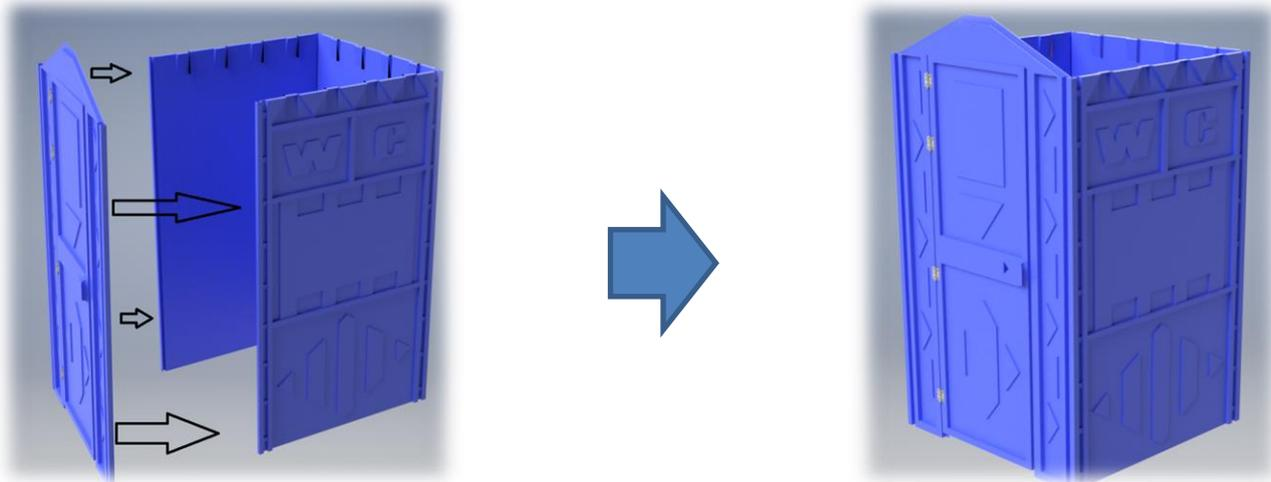
3.7. Сверлить и заклепать стык панели с аркой лепестковой заклепкой 4,8x12 мм.( ориентироваться на ребра жесткости) см. пункт 3.3.
