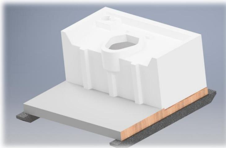
3.1.1. Установить каркас кабины на туалетный поддон с баком согласно эскизу.
