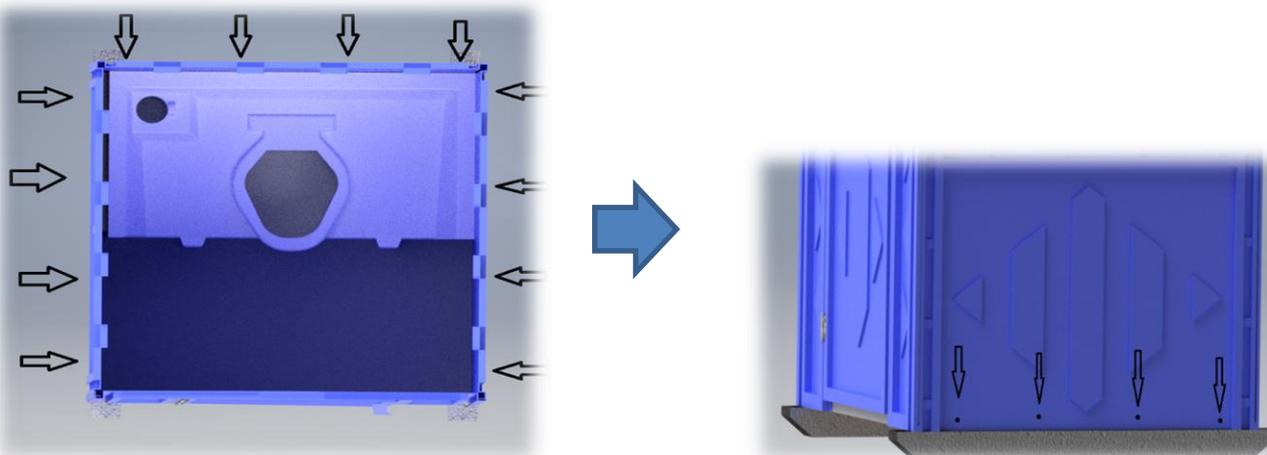
3.1.3. Закрепить деревянный поддон к «арки двери» на 5 самореза 6x40 мм, согласно эскизу.
