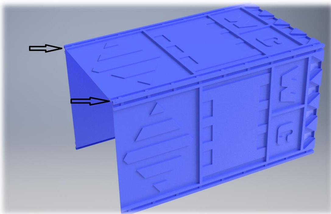
3.3. Сверлить отверстия в стыкавых пазах панели (ориентироваться на ребра жесткости) как изображено на эскизе.
