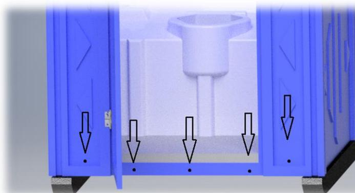
3.1.4. Для закрепления бака в четырех местах, просверлить отверстие в боковой панели вместе с баком и заклепать лепестковой заклепкой (4,8x18 мм).
