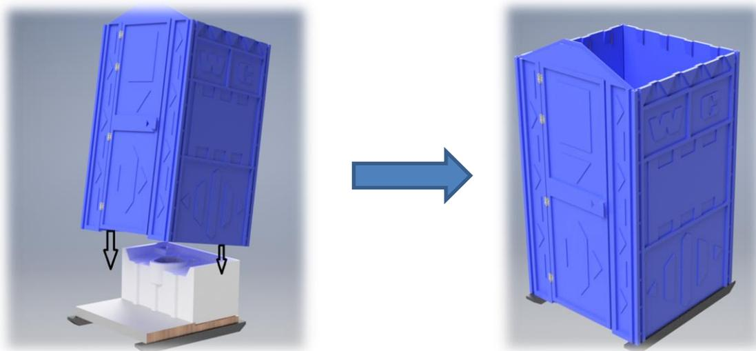
3.1.2. Закрепить деревянный поддон к трем панелям при помощи 12 саморезов 6x40 мм.
